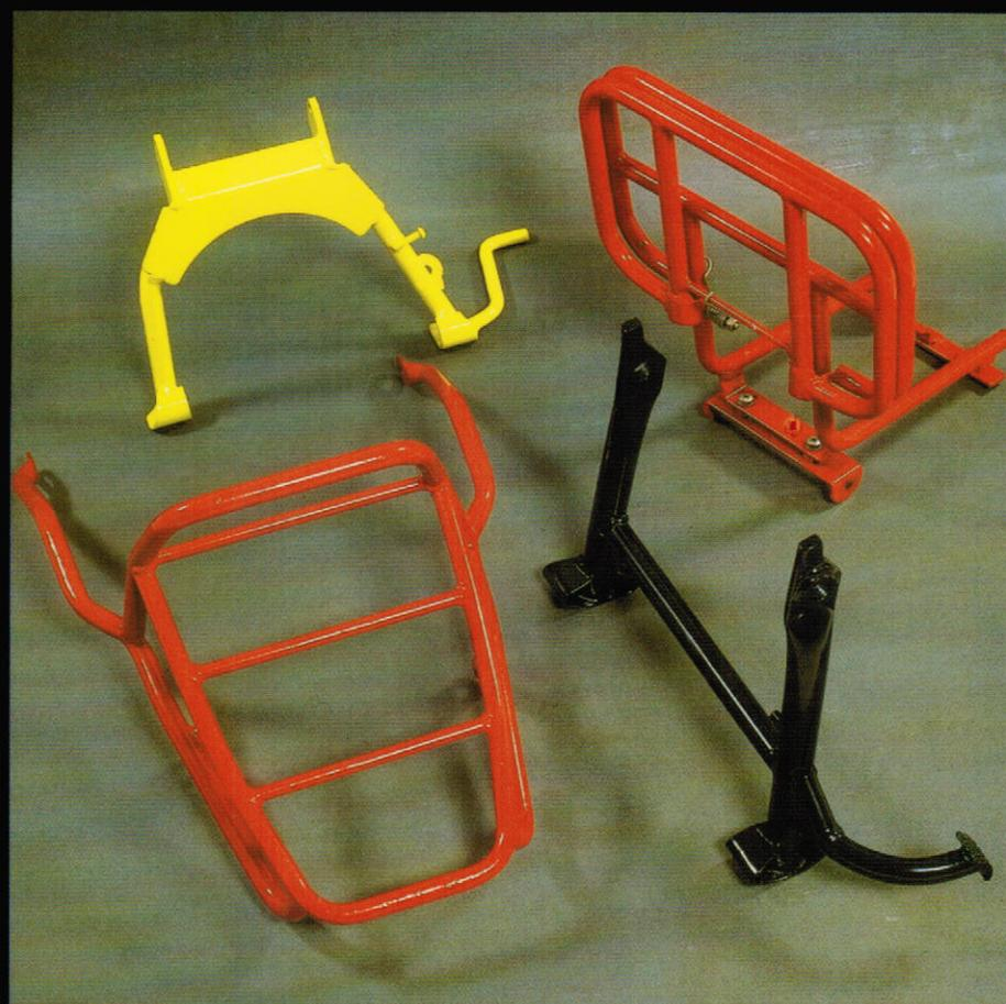
La massima flessibilità di lavorazione ci consente di produrre una vasta gamma di prodotti in piccola, media e grande serie. Ogni prodotto saldato è assemblato in maschere di montaggio per ridurre al minimo le deformazioni dovute ai ritiri della saldatura. Se necessario viene eseguita una lavorazione di calibratura prima della consegna.
